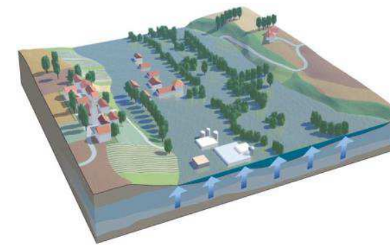
inondation de nappe
